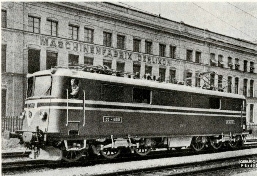
Moderne elektrisk lokomotiv af europæisk type til 50 p/s vekselstrøm. To bogier med ialt 6 aksler. Alle aksler er drivaksler. 4300 hkr., 104 t. Eksperimentalttype, der bruges af de Franske Nationalbaner på en alpestrækning i nærheden af Mt. Blanc.
